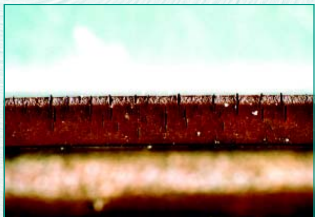
Bild 34: Härterisse an der statischen Dichtlippe
