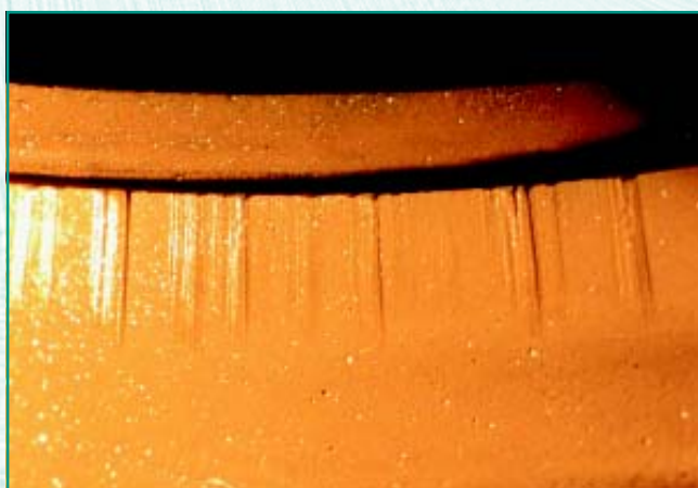
Bild 37: Riefen und Rillen an der dynamischen Dichtlippe
