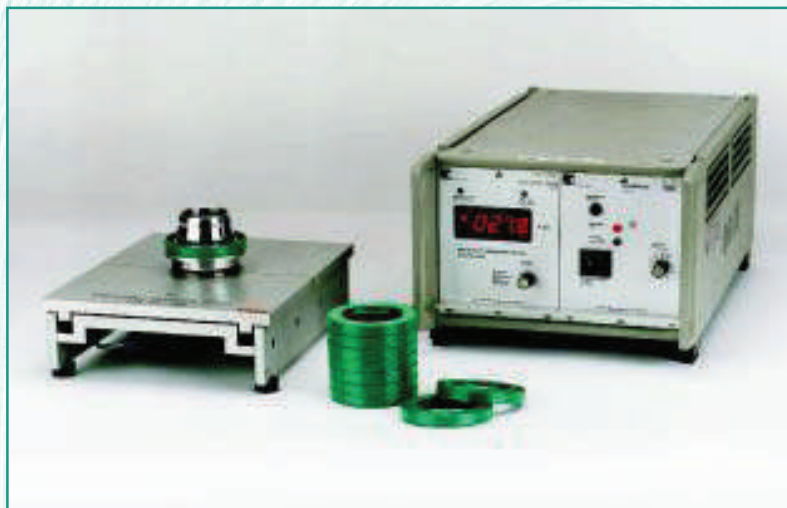
Bild 33: Elektronisches Radialkraftmeßgerät Messung nach DIN 3761 Teil 9
